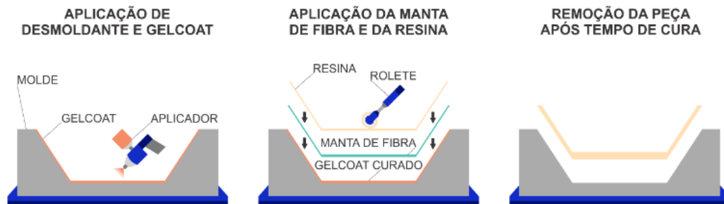
Figura 7 - Processo de laminação manual
