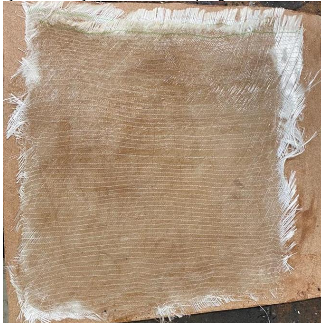
Figura 31 - Material compósito com duas camadas de tecido de fibra de vidro com 460 \text{ g/m}^2 de gramatura e reforços entrelaçados em 45^\circ impregnados com matriz de resina epóxi
