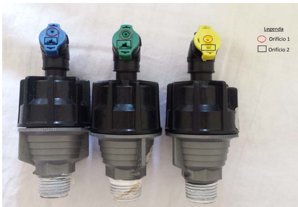
Figura 1. Modelos do aspersor NaanDanJain Super 10 de bocais azul, verde e amarelo
