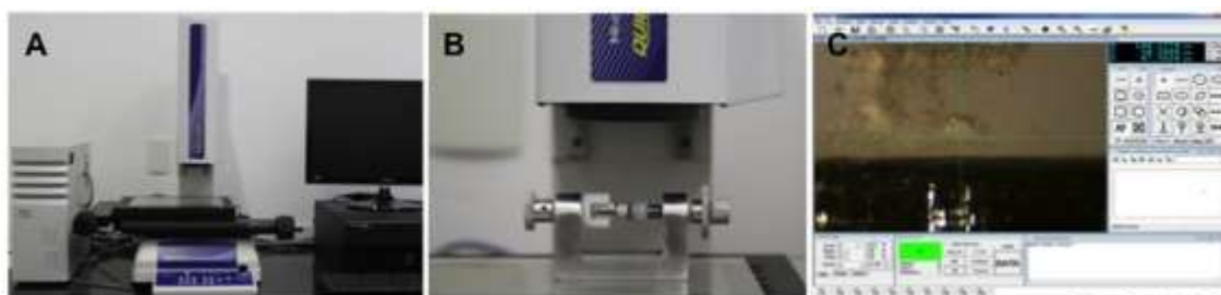
Figura 6: (A) Microscópio óptico tridimensional (Quick Scope-Mitutoyo). (B) Conjunto dispositivo/matriz/infraestrutura sob a mesa digital do microscópio para posteriores análises de desadaptações. (C) Imagem ilustrativa do programa computacional interligado ao microscópio para as mensurações.
