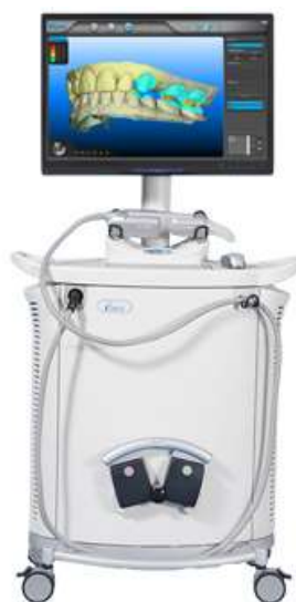
Figura 4: Câmera de aquisição de dados do sistema iTero. Imagem retirada do site http://www.dentalimplantpro.com/procedures/itero-digital-impressions/ . Data 21/11/2016.
