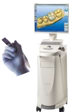
Figura 3: Detalhe da câmera de aquisição de dados do Sistema Cerec Bluecam (Sirona), adquirido por auxílio concedido - Auxílio Fapesp (2011/19150-7). Imagem retirada do site http://www.sirona.com.br/br/produtos/sistemas-cad-cam/cerec-chairside-solutions/?tab=2557 . Data 21/11/2016).
