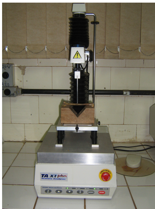
Figura 3. Equipamento Texture Analyser TA. XT Plus e sonda Blade Set HDP/BS utilizados nas análises de resistência óssea.
