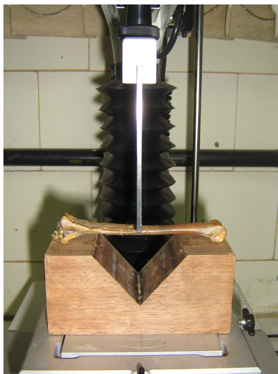
Figura 4. Posição da peça óssea durante as avaliações de resistência óssea.
