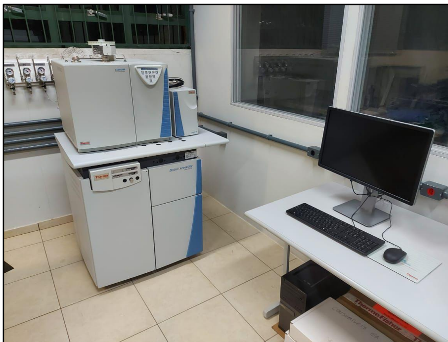
Figura 11. Espectrômetro de Massa de Razão Isotópica – IRMS – EA Flash 2000 Delta V Advantage e TC/EA, da ThermoFisher Scientific™
