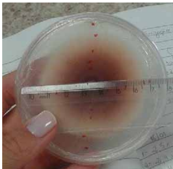
Figura 3. Metodologia para caracterização biológica dos isolados. Mensuração dos diâmetros das colônias com régua milimétrica.
