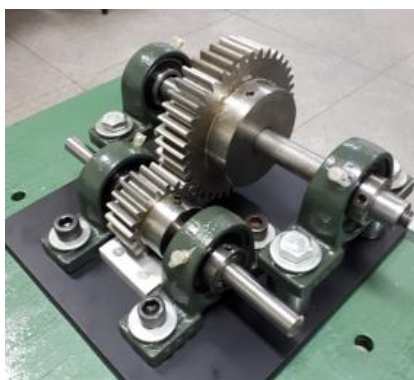
Figura 5 - Montagem do experimento com engrenagens de aço
