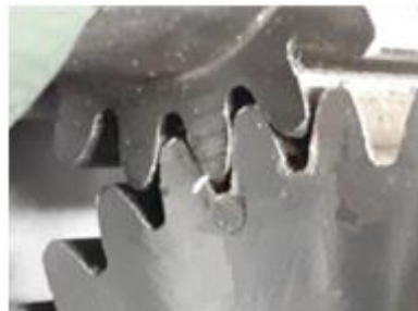
Figura 8 - Engrenamento entre o pinhão e a coroa utilizados, mostrando o número de dentes em contato
