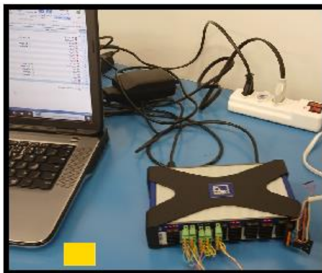
Figura 27 - Sistema de aquisição de dados HBM utilizado no ensaio de tração
