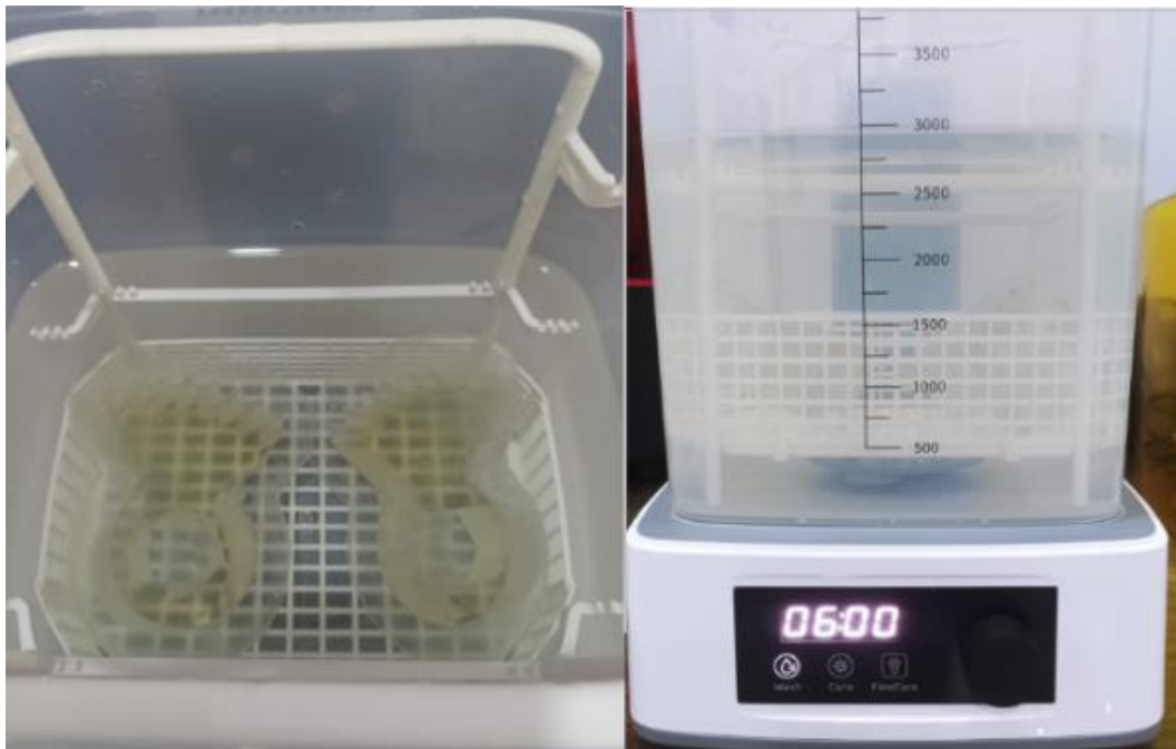
Figura 93 – Remoção do excesso de resina não curada na impressora
