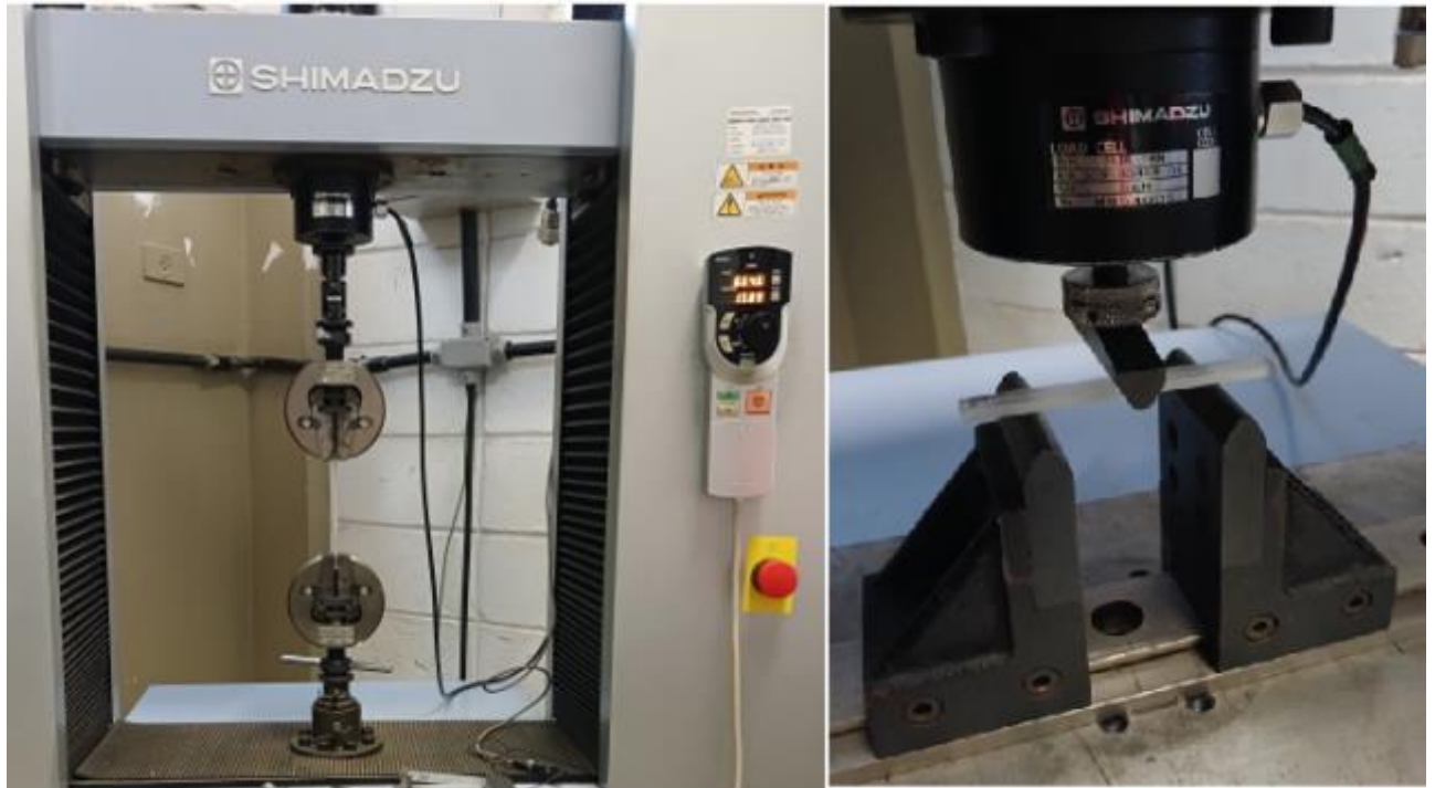
Figura 20 - Máquina universal com equipamentos para o ensaio de tração e flexão.
