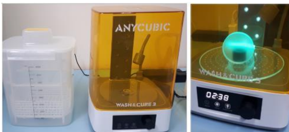
Figura 53 - Cuba de lavagem, cabine de cura e disco sob luz UV
