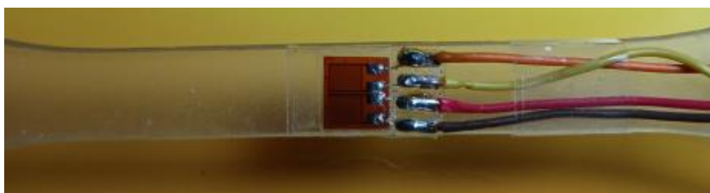
Figura 28 - Extensômetro fixado no CDP de ensaio de tração
