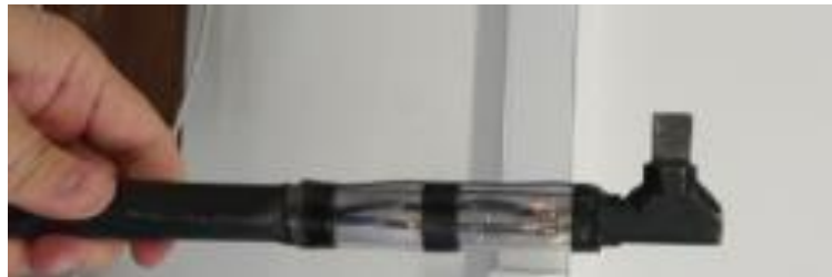
Figura 13 - Torquímetro com extensômetros para aquisição do torque em tempo real
