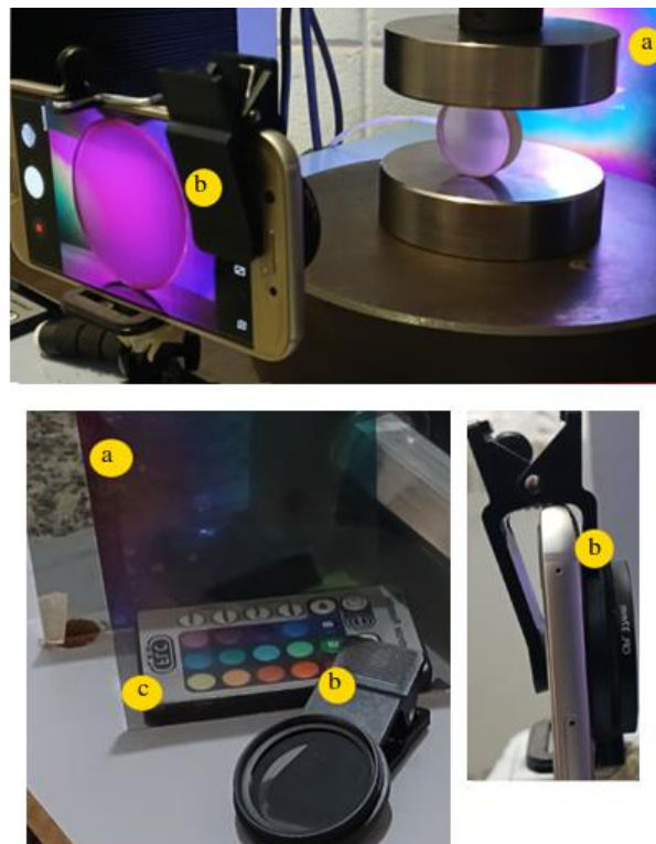
Figura 67 - Configuração de aquisição de vídeo para o teste de fotoelasticidade e componentes utilizados: (a) filme polarizador, (b) lente CPL e (c) controle da fonte de luz LED.
