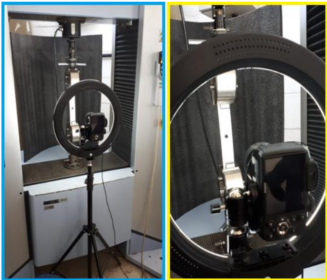
Figura 36 - Ensaio DIC na chapa fina
