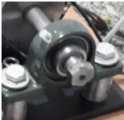
Figura 14 - Novo parafuso soldado na extremidade do eixo
