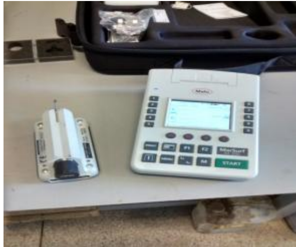
Figura 20: Rugosímetro marca Mahr modelo Marsurf M300
