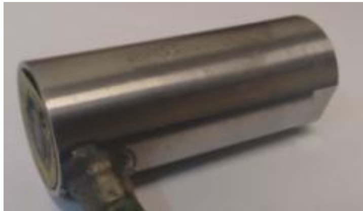
Figura 18: Sensor de vibração modelo TV-100
