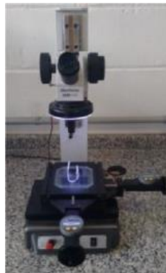
Figura 19: Microscópio de medição Mahr
