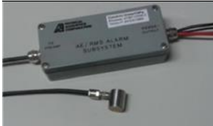
Figura 17: Sistema de captação da emissão acústica da marca Physical Acoustics Corporation
