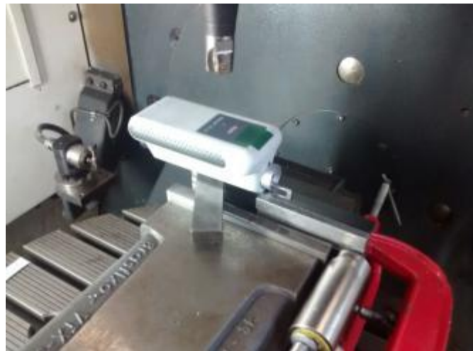
Figura 21: Medição da rugosidade sendo realizada
