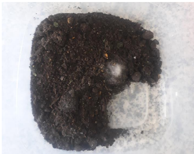
Figura 22 – Interior de respirômetro contendo amostra de solo com sinais de desenvolvimento de fungos após 35 dias de avaliação.
