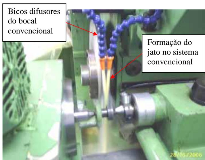
Figura 3.1 – Sistema convencional para aplicação de fluido de corte, com dois bicos difusores em operação.
