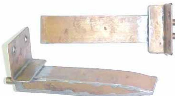
Figura 3.5 – Vistas do bocal utilizado na experimentação com MQL.
