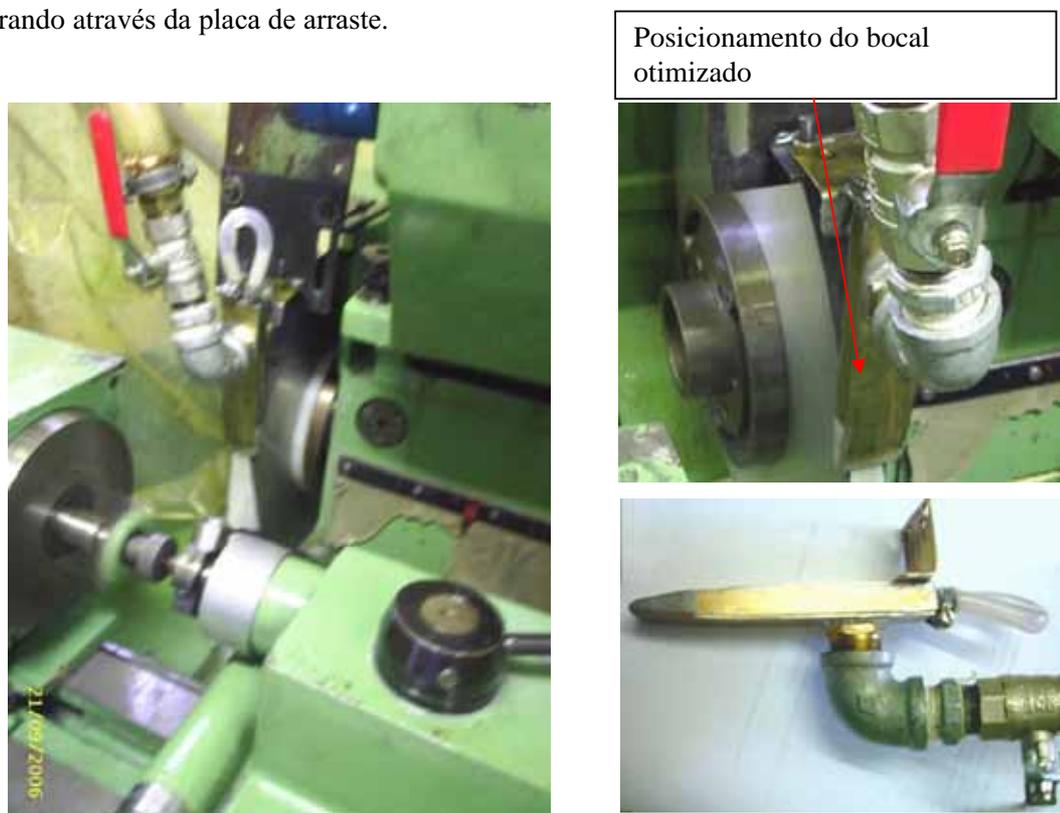
Figura 3.12 – Formação do jato de fluido de corte com o Bocal Otimizado.
