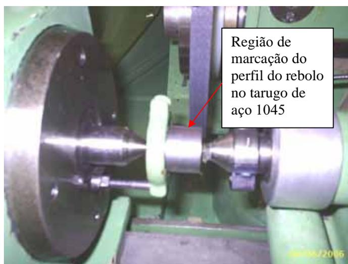
Figura 3.18- Sistema de fixação do corpo de prova (ABNT 1045) pra marcação do desgaste do rebolo
