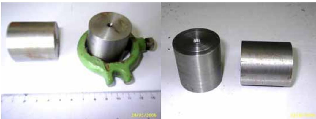
Figura 3.17 – Geometria do corpo de prova usado para a marcação do desgaste do rebolo
