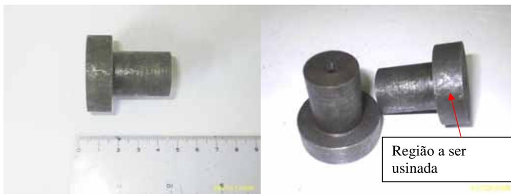
Figura 3.15 – Geometria do corpo de prova em aço ABNT 4340 temperado e revenido
