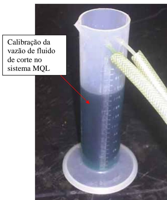
Figura 3.9 – Sistema para a medição da vazão de fluido de corte no sistema MQL.
