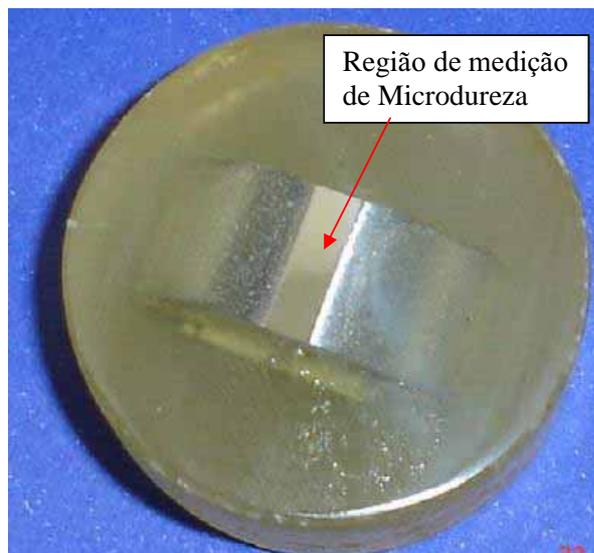
Figura 3.44 – Amostra utilizada para análise de microdureza
