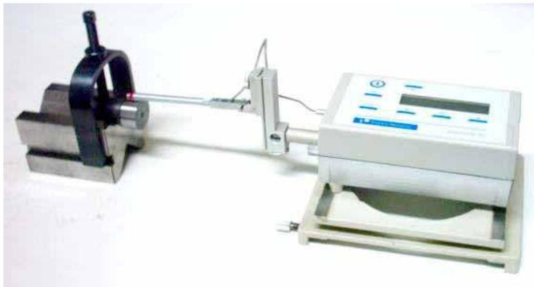
Figura 3.33 – Exemplo da disposição dos equipamentos para a medição da rugosidade ( $R_a$ )
