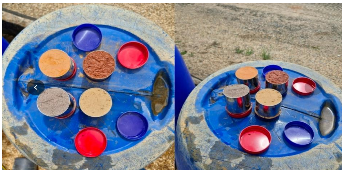
Figura 4. Cilindros metálico para análise química e granulométrica de solo.
