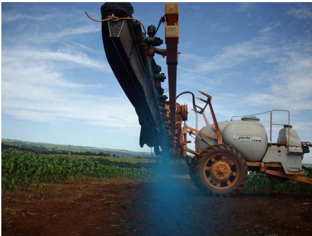
Figura 2. Pulverização com o equipamento Advanced Vortex 2000 do marcador corante alimentício Azul Brilhante (FD&C nº 1) adicionado à calda. Botucatu-SP, 2009.
