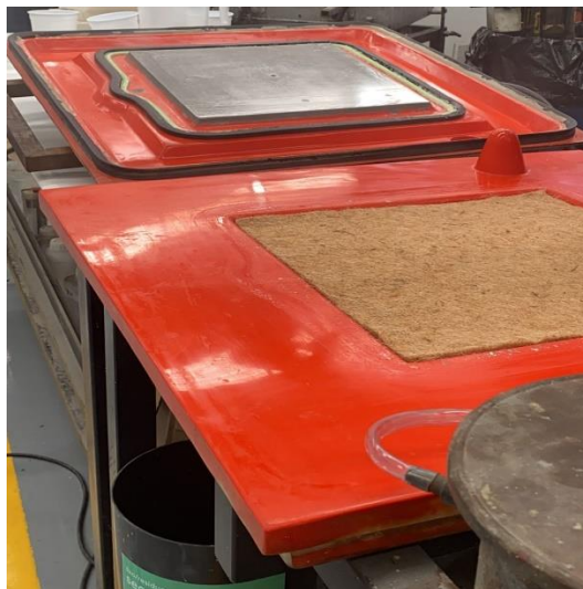
Figura 14 - Manta de fibra natural de Juta reforçada com tecido de fibra de vidro.
