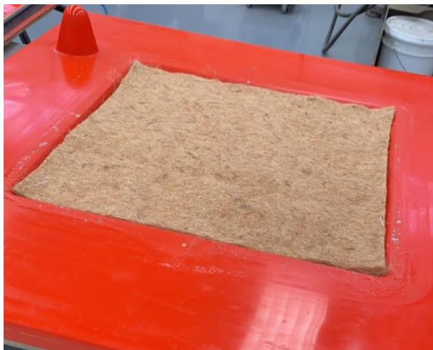
Figura 12 - Molde manteado com fibra natural de juta.
