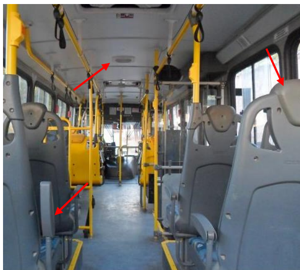
Figura 17 - Itens representativos que foram substituídos por peças produzidas de maneira híbrida para teste.
