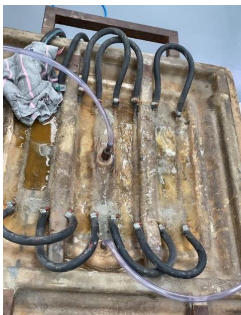
Figura 11 - Sistema de aquecimento do molde e contramolde por serpentinas.
