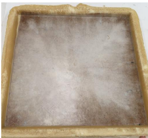
Figura 20 - Peça produzida com manta de Fibra Natural de Juta reforçada com Tecido de fibra de Vidro.
