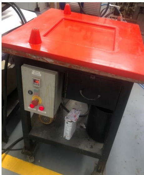
Figura 9 - Molde aquecido utilizado para a produção dos corpos de prova.
