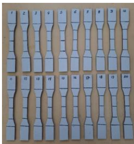
Figura 16 - Corpos de prova para os ensaios mecânicos. a) Corpos de prova para ensaios de tração. b) Corpos de prova para ensaio de flexão.
