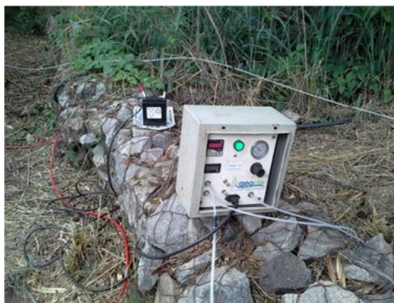
Foto 11- Painel com filtro regulador de ar comprimido utilizado no ensaio
