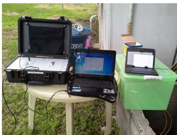
Foto 10- Sistema de aquisição de dados utilizado nos testes
