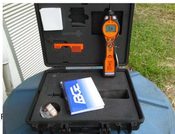
Foto 13- PID utilizado para a medição das concentrações de VOC's nos vapores extraídos.
