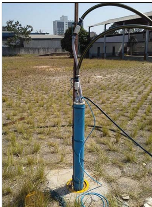
Foto 7- Detalhe do poço de extração utilizado no ensaio DPE.
