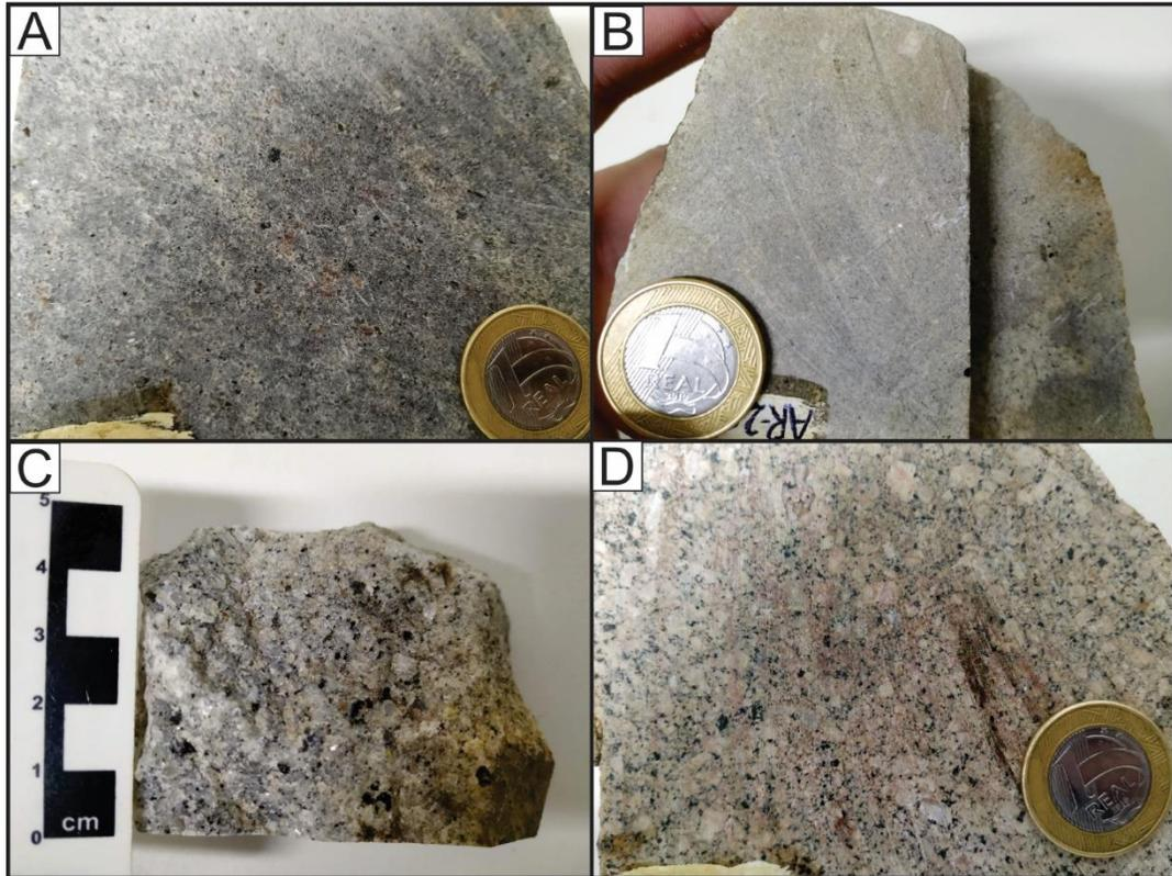
**Figura 5.2.** Granitos porfiríticos de matriz fina do maciço Santa Cruz. A) amostra WB-213B, Anfibólio sódico biotita álcali feldspato granito cinza porfirítico. B) amostra AR-20, Biotita sienogranito porfirítico de matriz fina. C) amostra WB-275B, Anfibólio sódico biotita álcali feldspato granito. D) amostra WB-276B, Hornblenda biotita sienogranito porfirítico.
