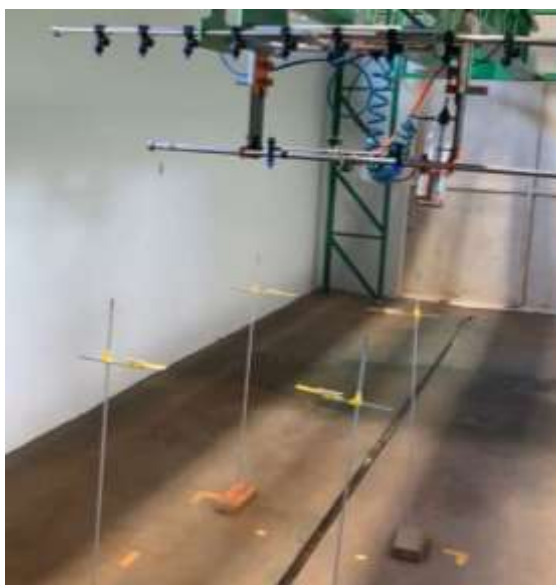
Figura 4. Hastes de apoio com papel sensível à água (PSA) fixado a uma altura de 50 cm em relação a ponta de pulverização.
