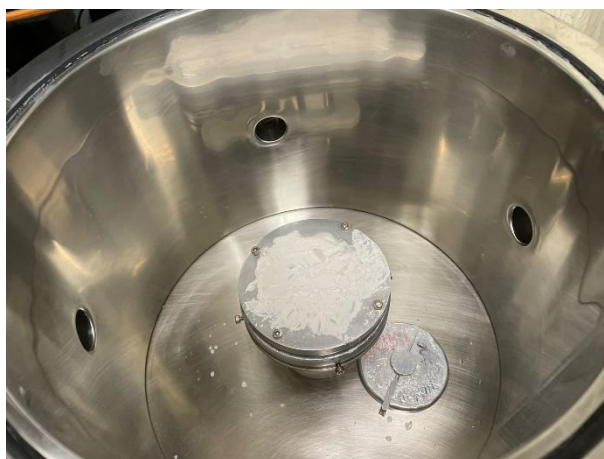
Figura 3.3 - Alvo confeccionado com pó de cério diluído em álcool isopropílico.
