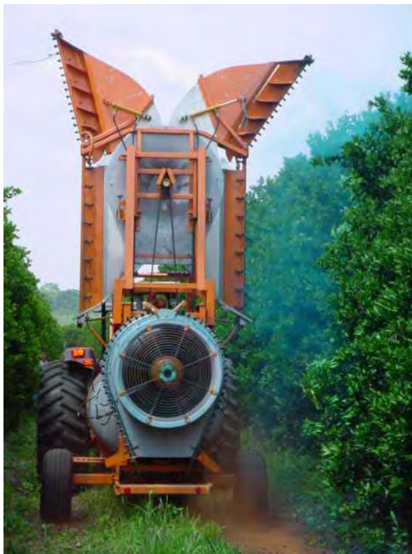
Figura 10 Vista do equipamento Arbus “Ventilador Duplo” (2 VENT) na versão final em operação na parcela aplicando calda com corantes.
