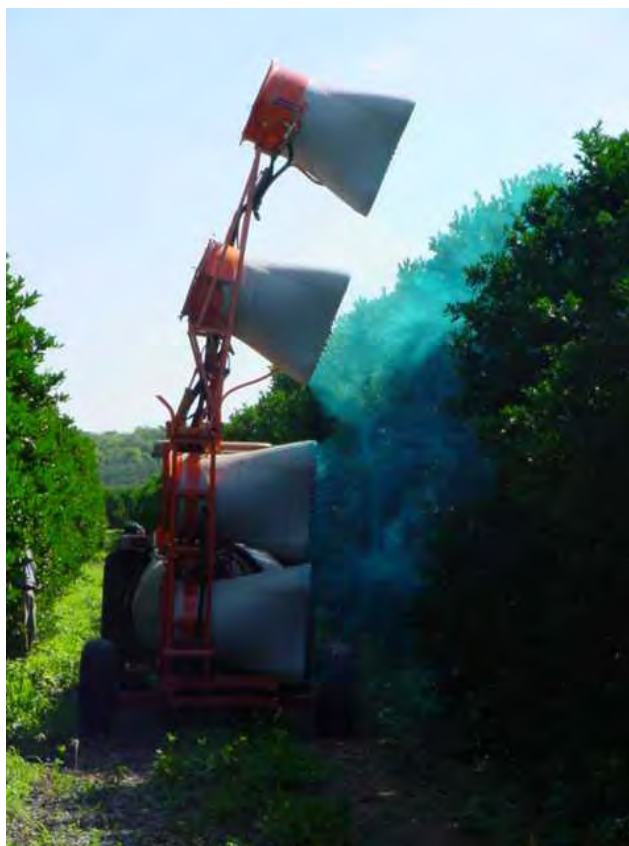
Figura 8 Equipamento Arbus 4 ventilador (4 VENT) na versão final em operação na parcela aplicando calda com corantes.
