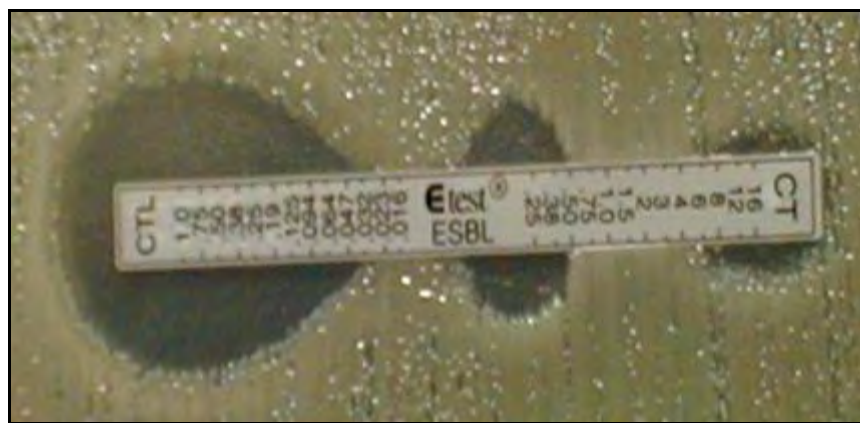
Figura 3. Fita de Etest ® para ESBL. Uma extremidade impregnada com concentrações crescentes de cefotaxima (CT) e a outra com concentrações crescentes de cefotaxima+ácido clavulânico (CTL).
