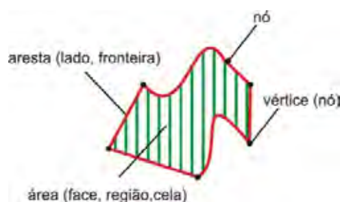
Figura 52: Partes componentes de um Módulo bidimensional
