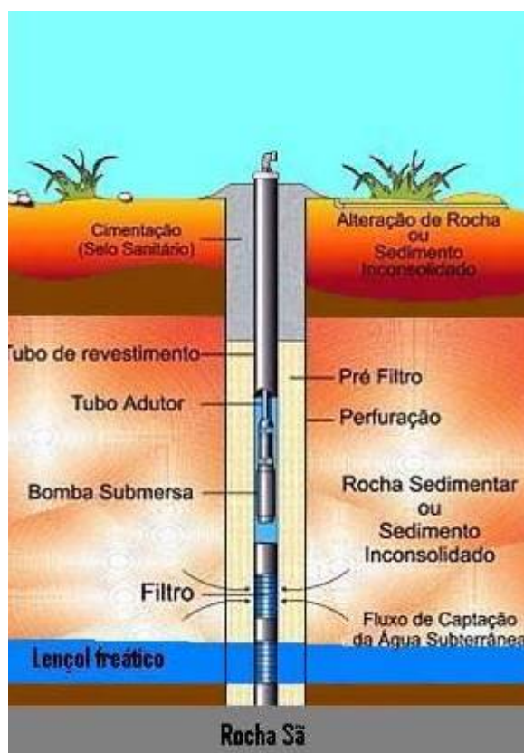
Figura 4-21. Elementos constituintes da complementação de um poço
