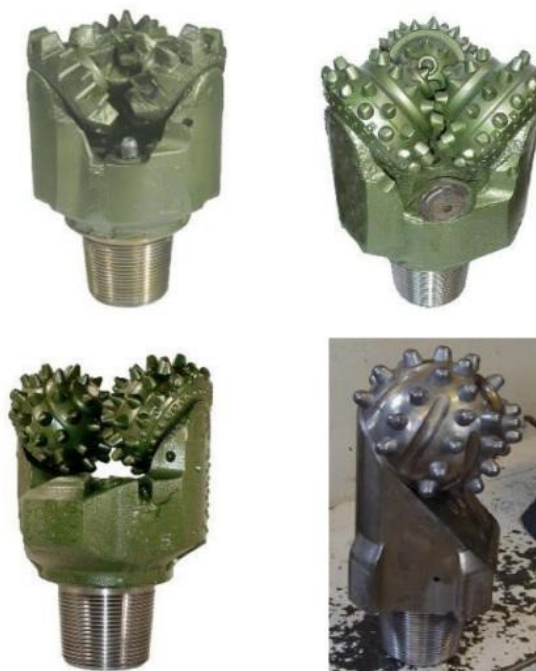
Figura 4-16. Principais tipos de brocas rotativas
