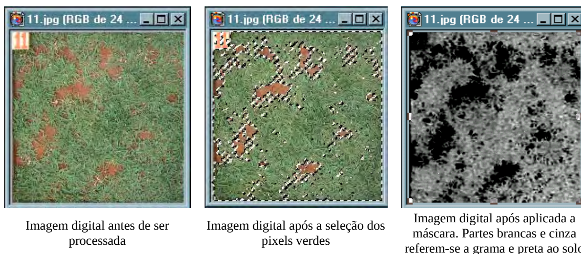
Figura 5. Análise da imagem digital para determinar a taxa de cobertura do solo pela grama.
