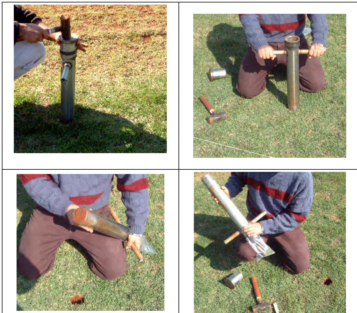
Figura 7. Coleta do “plug” de grama com a utilização do trado amostrador, para a determinação da fitomassa seca de raízes, rizomas/estolões, e folhas + caules.
