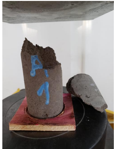
Figura 12: Corpos de prova devidamente identificados, durante (esquerda) e após (direita) processo de rompimento para ensaio a compressão. Fonte: Próprio autor
