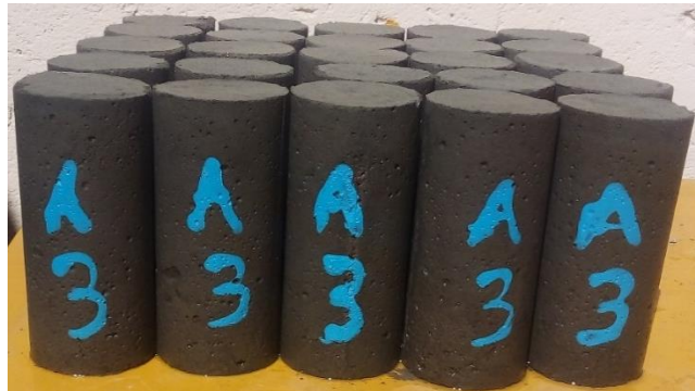
Figura 8: Corpos de prova cilíndricos após desmoldagem. Fonte: Próprio autor
