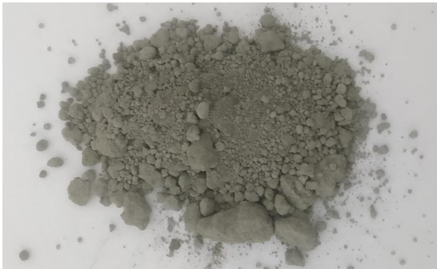
Figura 2: Resíduos Dregs após secagem, com variada gama granulométrica. Fonte: Próprio autor
