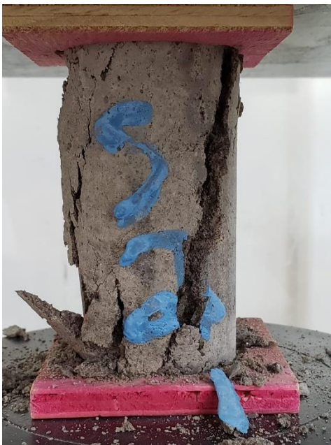
Figura 12: Corpos de prova devidamente identificados, durante (esquerda) e após (direita) processo de rompimento para ensaio a compressão. Fonte: Próprio autor
