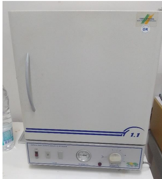
Figura 14: Estufa utilizada na secagem dos corpos de prova. Fonte: Próprio autor
