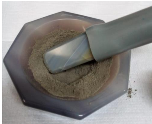
Figura 4: Dregs sendo triturado em almofariz. Fonte: Próprio autor
