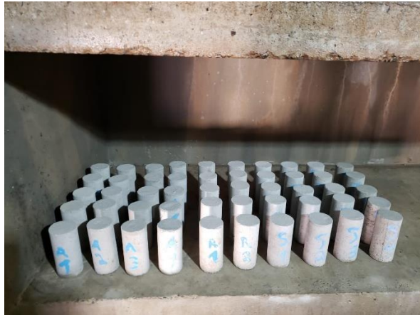
Figura 11: Corpos de prova devidamente organizados e identificados para o processo de cura. Fonte: Próprio autor
