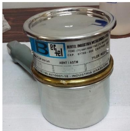
Figura 5: Peneira utilizada para o controle de tamanhos de grãos do Dregs. Fonte: Próprio autor
