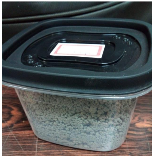
Figura 3: Dregs após secagem, acondicionado em recipiente de plástico rígido. Fonte: Próprio autor
