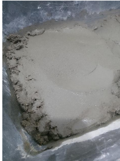
Figura 9: Argamassa obtida por meio de mistura manual dos constituintes. Fonte: Próprio autor
