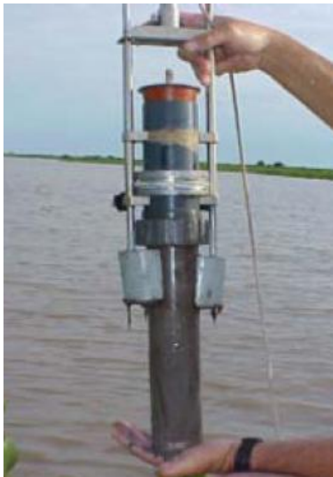
Figura 6 - Foto ilustrativa (exemplo) do coletor semi-automático tipo “core”.
