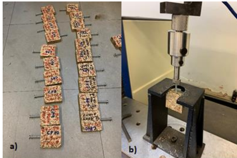
Figura 26: a) Corpo de prova preparado para o ensaio de Parafuso Topo b) Corpo de prova a ser ensaiado acoplado nos acessórios da máquina universal de ensaio – Parafuso Topo.
