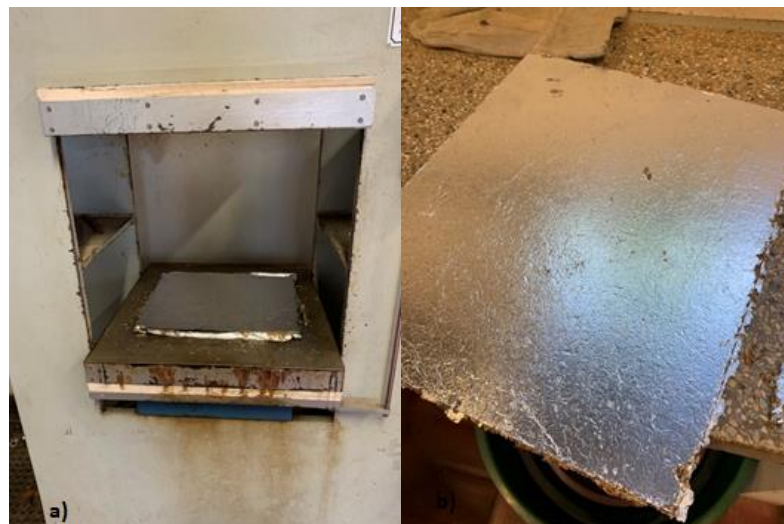
Figura 11: Painéis após prensagem a) painel com aro após a prensagem da peça; b) painel retirado da prensa hidráulica, sendo levado para retirada do aro.
