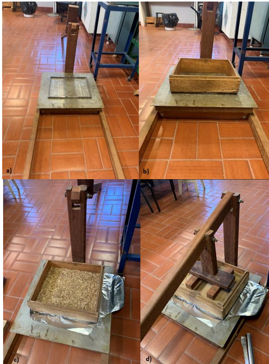
Figura 9: Etapas da Pré- Prensagem à Frio a) Aro e placa de metal para colocação do material a ser prensado; b) caixa de madeira para colocação do material; c) montagem de colchão para pré prensagem; d) Pré prensagem para formação do colchão.
