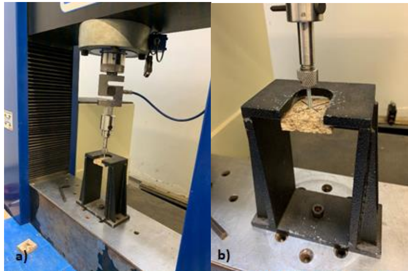
Figura 24: Corpo de prova a ser ensaiado acoplado nos acessórios da máquina universal de ensaios, Parafuso Face a) Corpo de prova posicionado para ensaio; b) corpo de prova sendo ensaiado.
