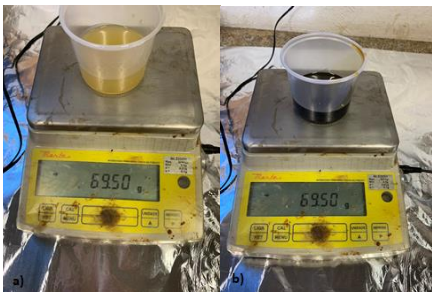
Figura 7: Proporção do Bicomponente de Mamona – 1:1 a) Poliól; b) Isocianato.
