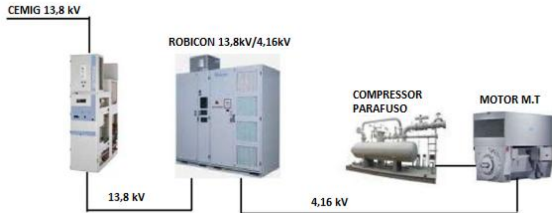
Figura 4.35 – Sistema completo de acionamento do motor.
