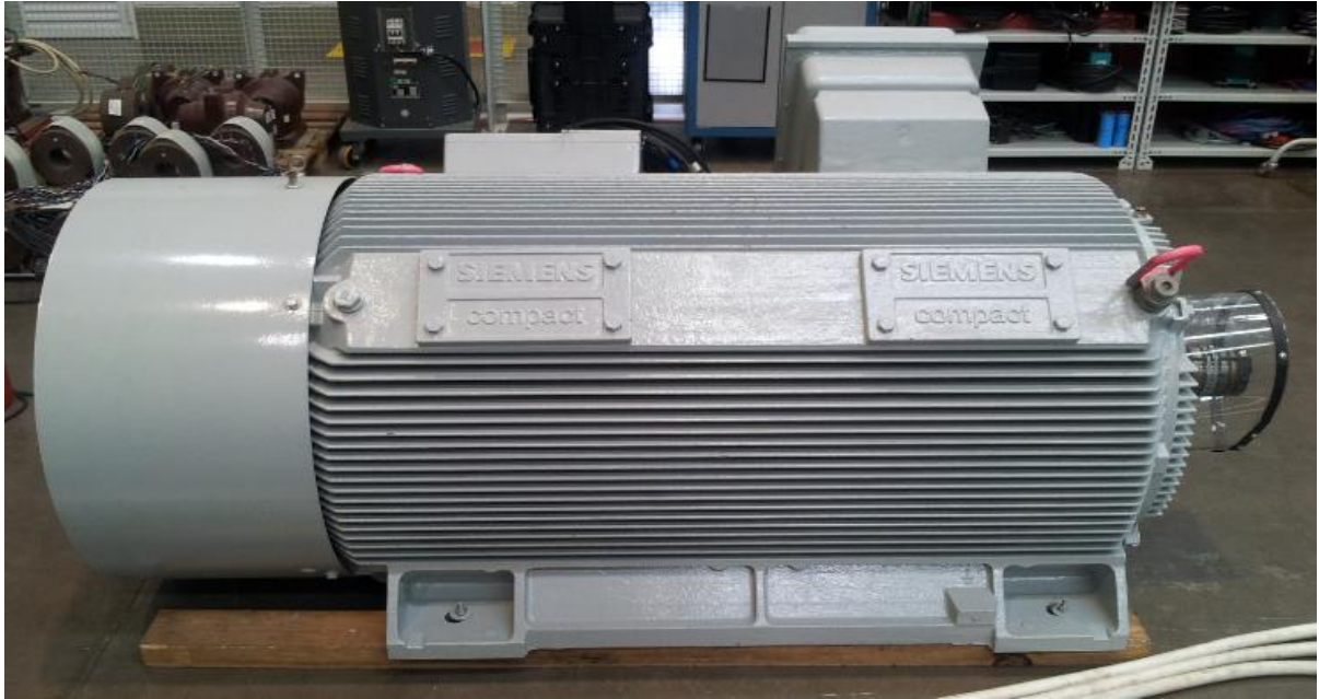
Figura 4.3 – Motor de Indução Trifásico SIEMENS modelo H-Compact ILA4.
