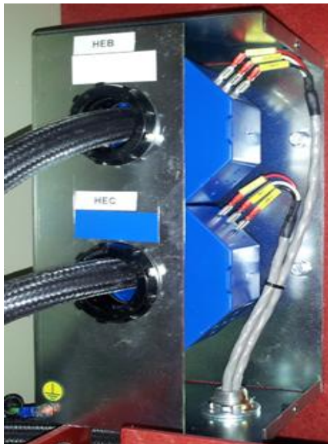
Figura 4.14 – Transdutor de corrente por Efeito Hall.
