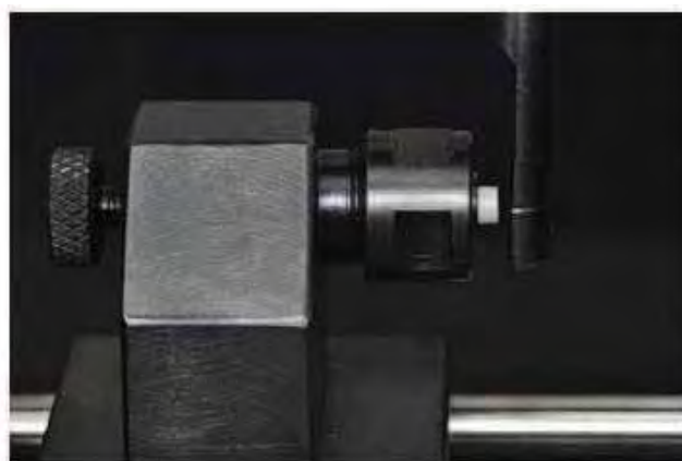
Figura 8 - Dispositivo confeccionado para o teste de RC.
