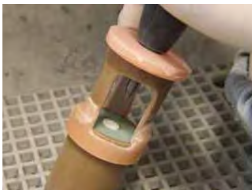
Figura 2 - Dispositivo padronizador do jateamento.
