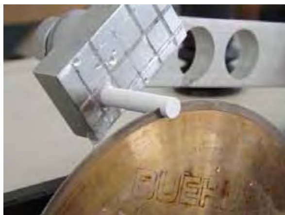
Figura 1 – Obtenção dos discos de zircônia.
