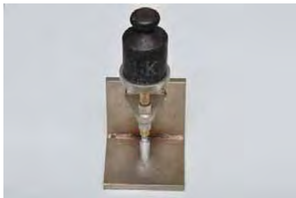
Figura 5 - Padronização da cimentação dos discos de zircônia.
