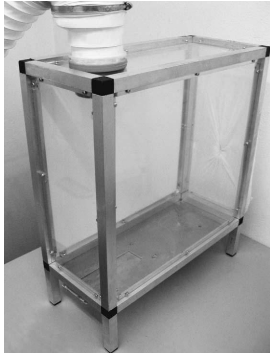
Figura 2. Caixa utilizada para a determinação da atividade repelente (OBERMAYR et al., 2010).
