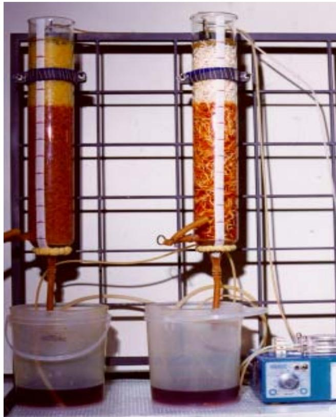
Figura 7. Sistema operacional utilizado para imobilização do *T. ferrooxidans*-LR.
