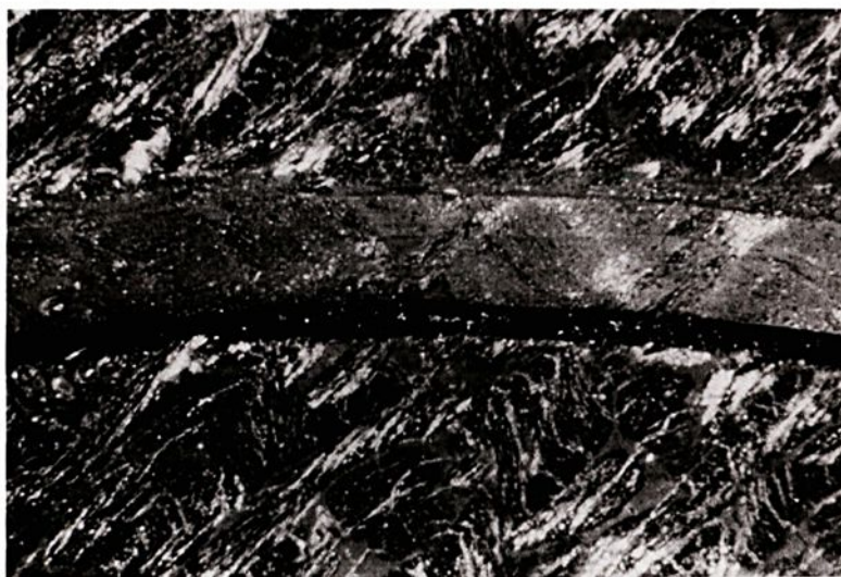
FIGURA 63 - Pista de deslizamento. Observa-se a região de desgaste total do disco de C/C
