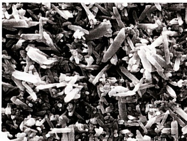
FIGURA 54 - Observa-se uma microestrutura predominante de grãos \beta - \text{Si}_3\text{N}_4 , em amostras sinterizadas sob pressão uniaxial a quente, com 5,0% de \text{Y}_2\text{O}_3 .
