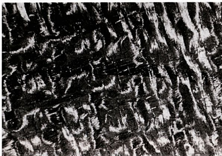
FIGURA 59 – Pista criada durante o teste de deslizamento pino contra disco, após 10 km.
