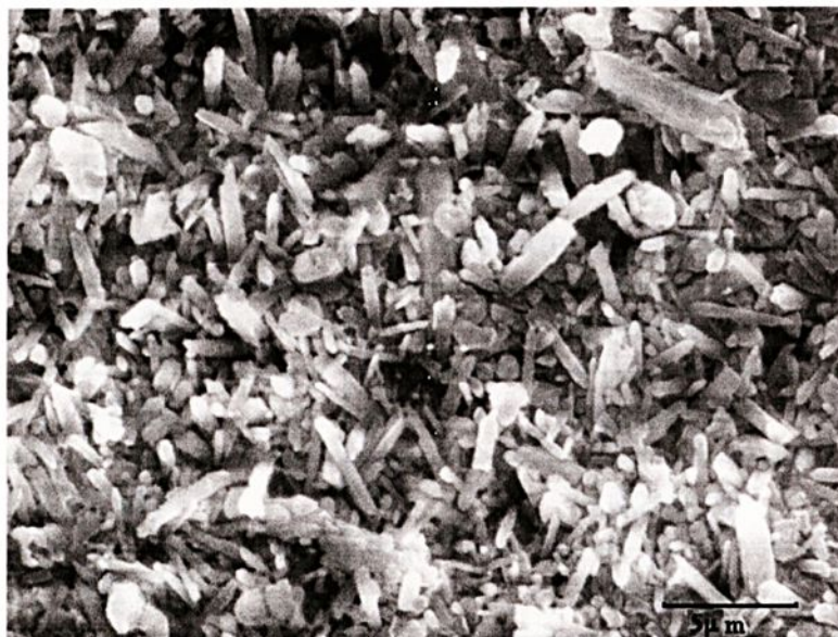
FIGURA 55 - Observa-se uma microestrutura predominante de grãos \beta - \text{Si}_3\text{N}_4 , em amostras sinterizadas sob pressão uniaxial a quente, com 10% de \text{Y}_2\text{O}_3 .
