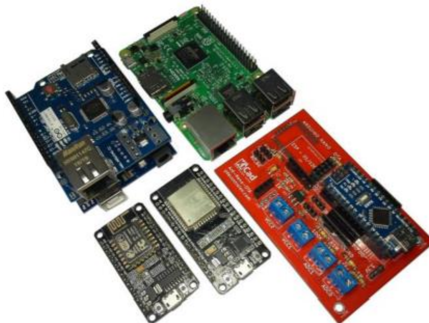
Figura 9 – Variedades de microcontroladores, na imagem: Arduino UNO e NANO, Raspberry PI, ESP32, ESP8266.
