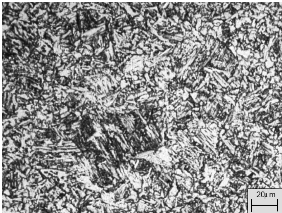
Figura 4.4 – Microestrutura do aço API 5L X70 austenitizado a 920°C e resfriado em óleo com taxa de 23°C/s. Ataque químico Nital 2%. Microscopia óptica.
