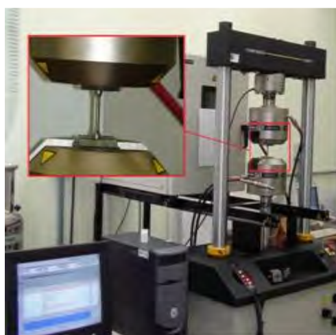
Figura 3.5 – Máquina utilizada para ensaios de tração marca Instron modelo 8801, equipamento do laboratório de fadiga (FEG/UNESP).
