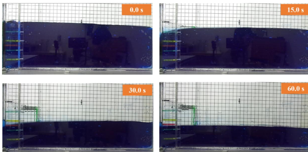
Figura 4.17 - Evolução do nível de fluido no interior do reservatório: possibilidade de avaliação de hidrogramas unitários das rupturas.
