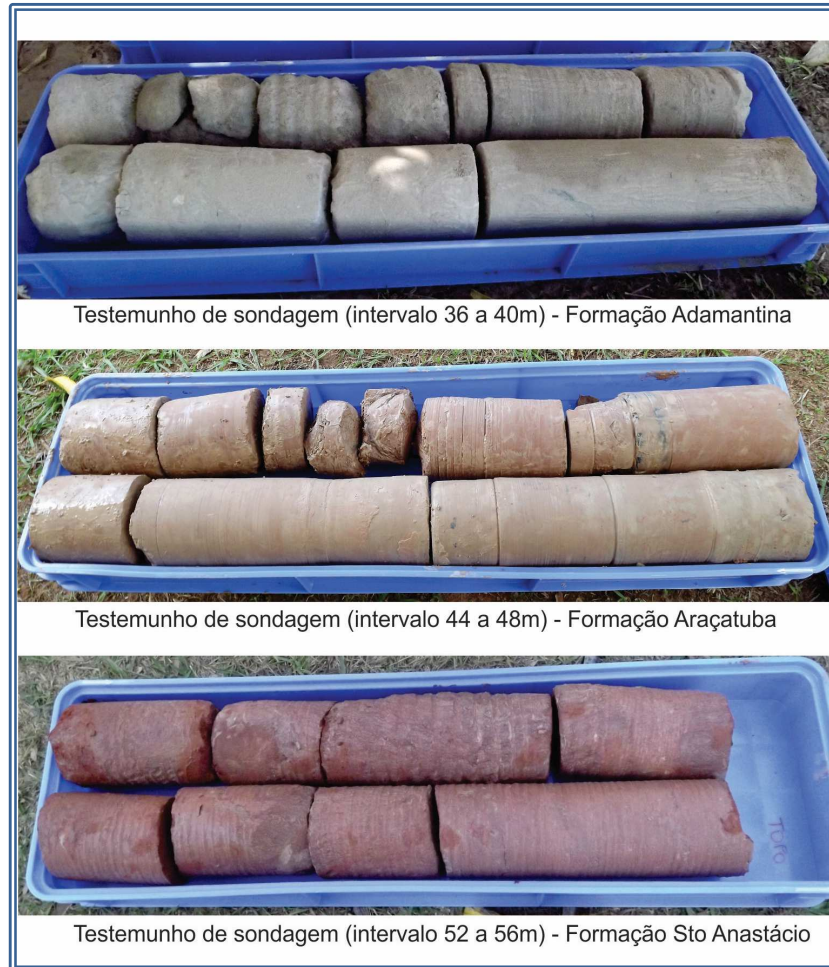
Figura 9 – Testemunhos de sondagem extraídos do poço P1 perfurado no município de Nova Granada - SP
