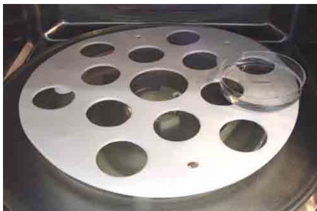
FIGURA 10 – Corpo-de-prova no interior do forno de microondas, para esterilização pela técnica 2.
