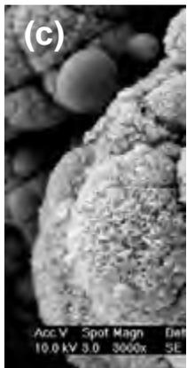
**Figura 27:** MEV-DRX da superfície da amostra B (Fluência  $56 \text{ J/cm}^2$ ) nos aumentos a) 200x, b) 500x, c) 1000x, d) 3000x e e) DRX.
