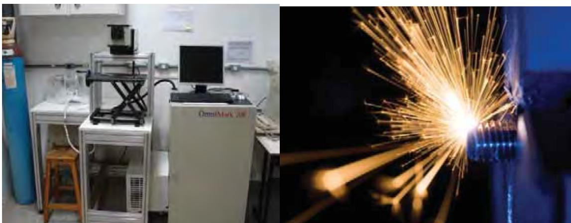
**Figura 13:** (a) Laser Ytterbium:YAG; (b) Irradiação com feixe de laser.
