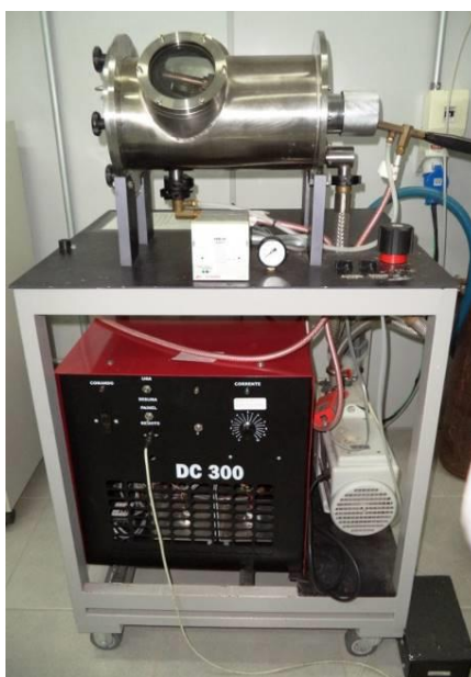
Figura 14 – Forno a arco voltaico utilizado para produzir as ligas.
