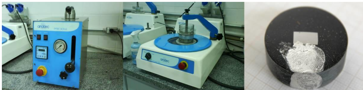
Figura 17 – Embutidora, politriz e amostra embutida em baquelite com um caminho de prata para observação no MEV.
