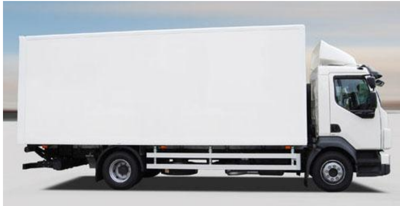
Figura 1 – Dispositivo de segurança e proteção lateral montado no caminhão.
