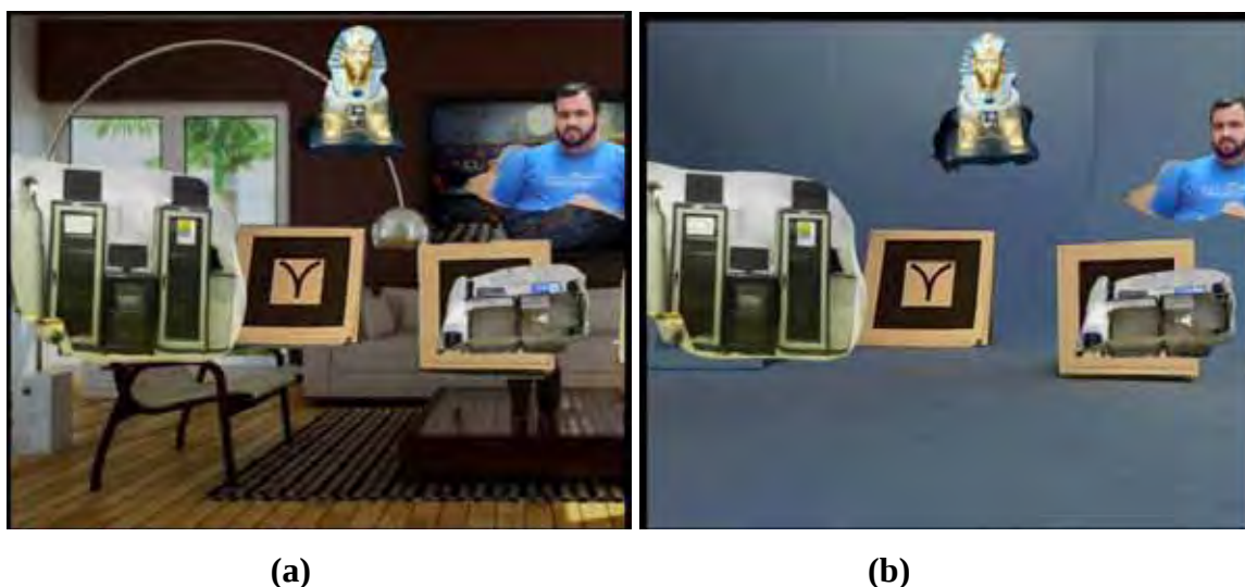
Figura 39 – Imagem em tempo real com objetos virtuais na cena. É possível ver alguns marcadores, o primeiro à esquerda desaparece quando o fundo do chroma-key é substituído. Em (a) a cena com o fundo removido e substituído por uma imagem. Em (b) cena sem o fundo removido e com os objetos nas mesmas posições.
