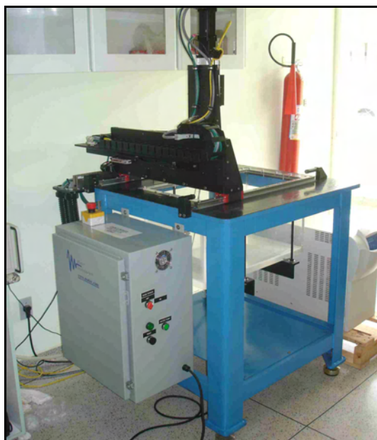
Figura 3.11 – Equipamento de inspeção por ultrassom utilizado na análise do compósito em estudo.
