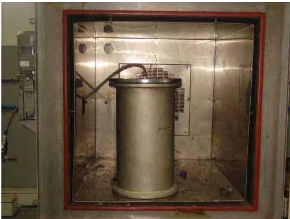
Figura 3.4 – Detalhe do vaso de pressão e estufa utilizado na produção do CRFC.
