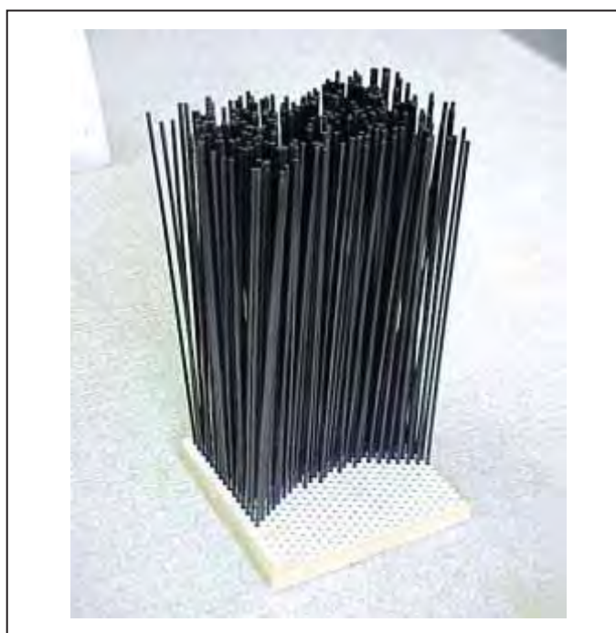
Figura 3.2 – Início da montagem da preforma 4D – planar 0/\pm 60 . Posicionamento de varetas na posição vertical, em gabarito de espuma de poliuretano.
