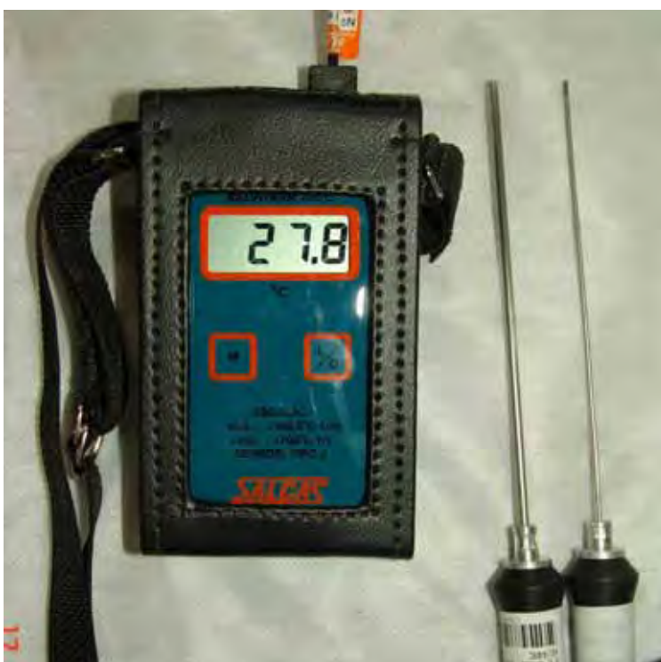
Figura 8 - Termômetro digital Salvterm 700C utilizado para quantificar a temperatura durante as fresagens.
