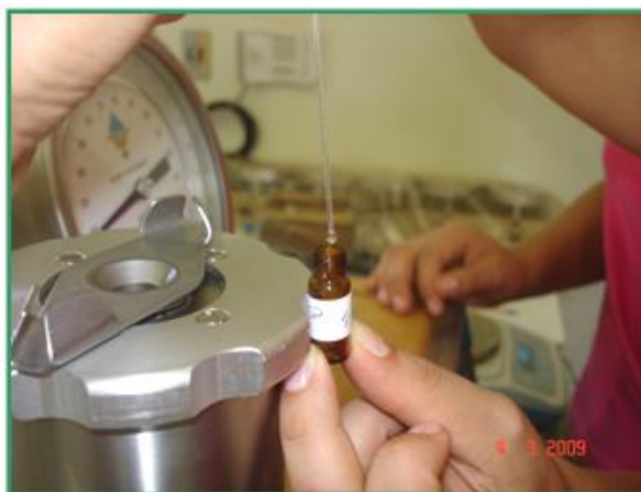
Figura 9. Metodologia de coleta da seiva do xilema extraída pela bomba de Schollander. Botucatu/SP - 2010.
