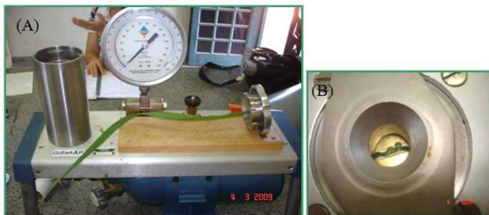
Figura 8. Extração da seiva do xilema com a bomba de Schollander. (A) visão geral da bomba de schollander com uma folha de cana-de-açúcar. (B) Liberação da seiva de folha de cana-de-açúcar através de pressões de gás nitrogênio. Botucatu/SP - 2010.
