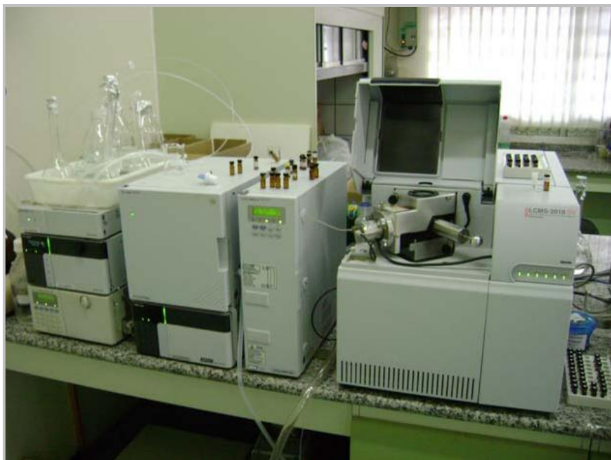
Figura 10. Cromatógrafo Líquido de Alta eficiência e espectrômetro de massas (LC/MS) utilizado no desenvolvimento do método analítico de determinação dos herbicidas. Botucatu/SP - 2010.
