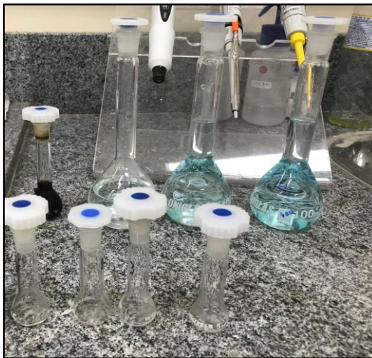
Figura 10: Preparo das soluções de interação lignina-Cu(II)
