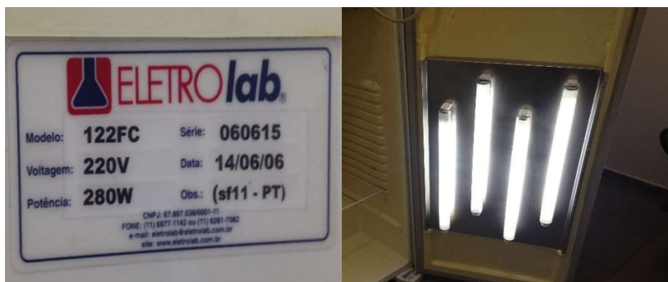
Figura 4. Identificação da estufa utilizada nos experimentos (à esquerda) e demonstração das lâmpadas dentro da estufa (à direita).
