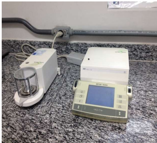
Figura 2. Balança de alta precisão XP6 com menor divisão 0,001 mg e máximo de 5,1 g.
