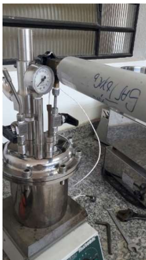
Figura 1. Reator de aço inoxidável com manômetro, já conectado a um cilindro de ^{13}\text{CO}_2 ; todos sobre um agitador magnético.
