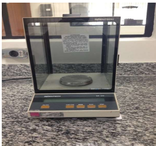
Figura 3. Balança de alta precisão SA210 com menor divisão 0,1 mg e máximo de 210,0 g.
