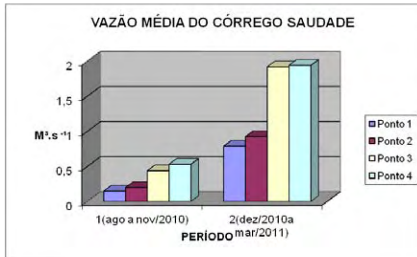
Figura 11: Vazão média do Córrego Saudade em quatro pontos de coleta nos períodos 1(agosto a Nov/2010) e período 2 (dez/2010 a mar/2011).
