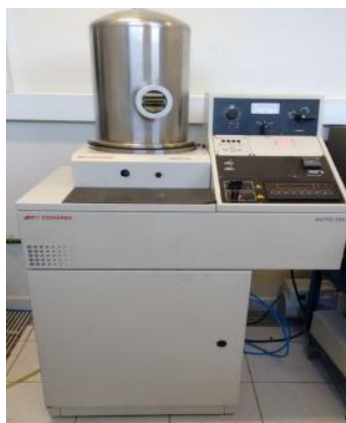
Figura 30 - Evaporadora Edwards (Auto 306 Evaporation System ) utilizada para evaporar materiais inorgânicos.
