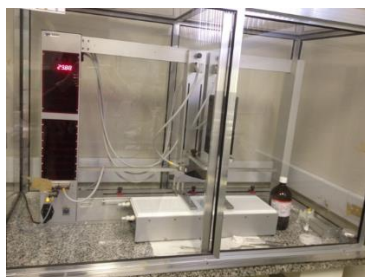
Figura 25 - Deposição em uma cuba de Langmuir modelo KSV 5000.
