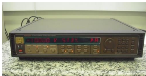
Figura 33 - Fonte de tensão DC utilizada para medida (Keithley modelo 238 SMU).
