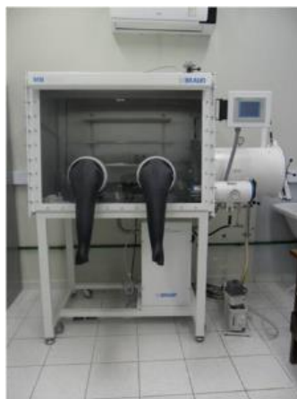
Figura 28 - Equipamento Glove Box Mbraun, 200B.
