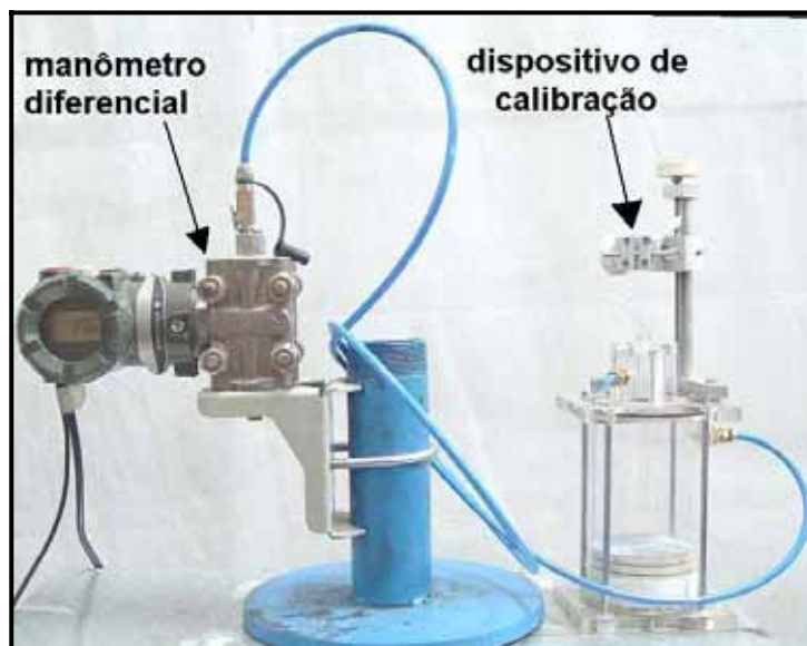
FIGURA 4.4 – Manômetro diferencial eletrônico e dispositivo de calibração por jato livre.
