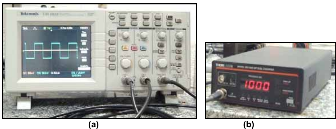
FIGURA 4.17 – Detalhes da montagem experimental: (a) osciloscópio digital e (b), controlador digital do chopper .
