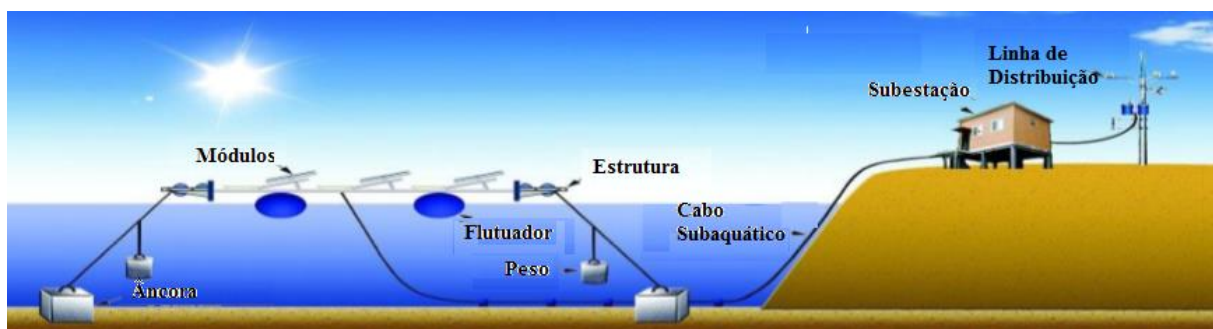
Figura 3 - Modelo esquemático de um sistema fotovoltaico flutuante.
