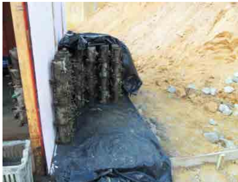
Figura 48 – Corpos de prova armazenados e protegidos por lona plástica contra a chuva e outras intempéries.
