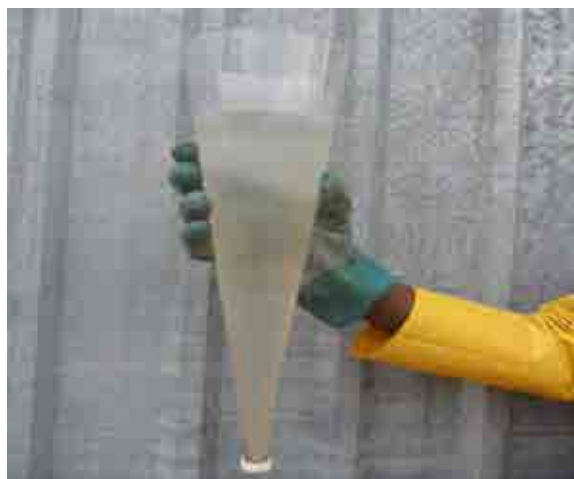
Figura 65 – Ensaio do cone IMHOFF realizada no canteiro de obras do empreendimento.
