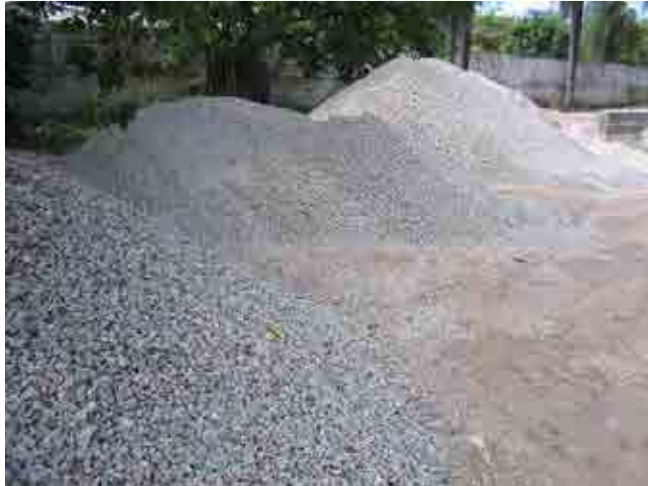
Figura 27 – Brita derivada do processo de reciclagem do concreto, com diâmetro inferior a 39 mm.
