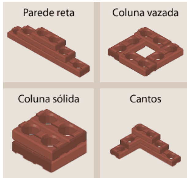
Figura 13 – Modos de utilização dos tijolos ecológicos.
